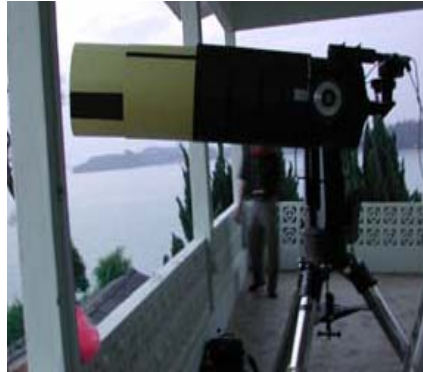
Rajah 5 - Peralatan yang digunakan ketika eksperimen sedang dijalankan. Kamera CCD dipasang pada belakang teleskop dan corong digunakan untuk mengurangkan kesan cahaya dari sekitar.
