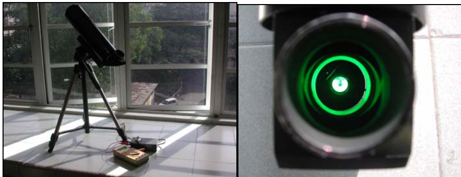
Rajah 4 – Kiri : Peralatan PBM yang terdiri dari bekalan kuasa bolehubah, multimeter digital dan tiub cahaya. Kanan: Imej yang kelihatan dari tiub cahaya apabila dihalakan kearah langit. Kecerahan LED dilaraskan supaya kecerahannya setara dengan kecerahan penapis berwarna tersebut.
